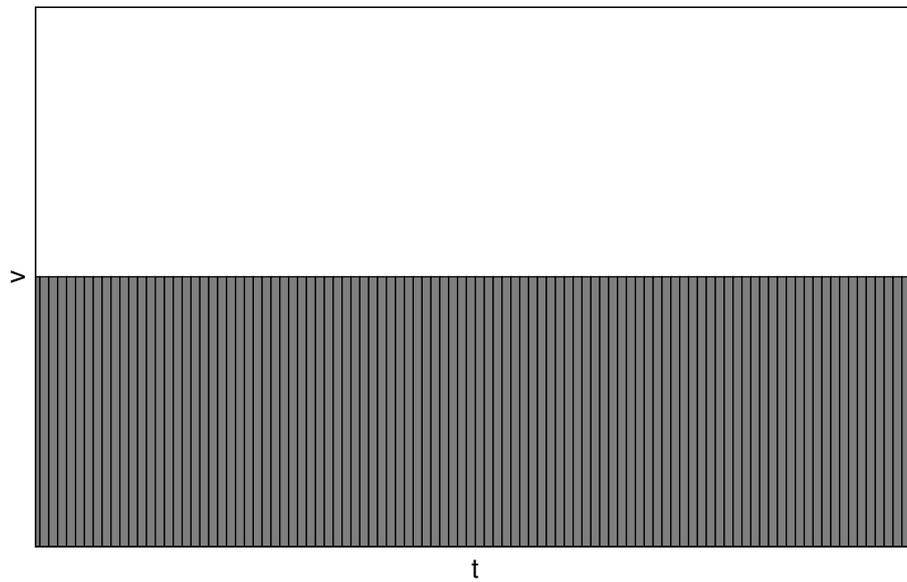
Die Fläche unter dem  $t$ - $v$ -Diagramm ist ein Maß für den zurückgelegten Weg  $x$ .
